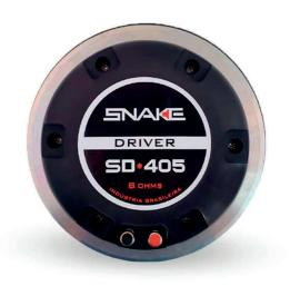
GARGANTA COM DIÂMETRO DE 2" PERMITE ACOPLAMENTO DIRETO EM CORNETAS COM ENTRADA DE MESMO DIÂMETRO SEM NECESSIDADE DE ADAPTADORES DIAFRAGMA FENÓLICO COM SUSPENSÃO BALANCEADA PARA RESPOSTA EXTREMAMENTE LINEAR EM TODA A FAIXA DE FREQUÊNCIAS ATÉ 7KHZ REPARO COMPLETO COM TERMINAIS DE LIGAÇÃO INCLUSOS, PERMITINDO TROCA RÁPIDA E FÁCIL SEM NECESSIDADE DE SOLDA 200 WATTS DE POTÊNCIA DE PROGRAMA MUSICAL E SENSIBILIDADE DE 111 dB SPL @ 1 W / 1m
